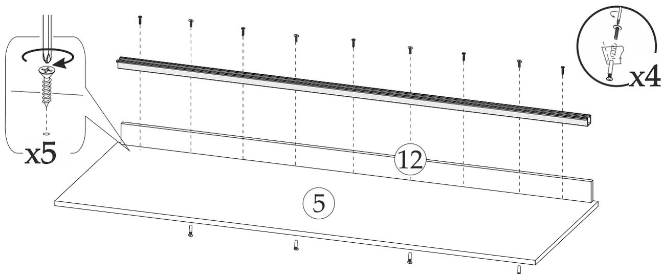
Направляющая СТ прикручивается на стяжки межсекционные 15 мм и дополнительно фиксируется шурупами 4x16
