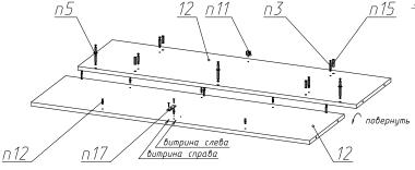
На средник, Деталь №12, установите штоки эксцентриков поз.3 и поз.5, шканты поз.15 и полкодержатели для стекла поз.11. Поверните деталь. Саморезами поз.8, закрепите ответную планку нажимного толкателя поз.17 и установите полкодержатели поз.12.
