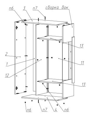
На схеме показана сборка шкафа с правым расположением витрины. Для сборки шкафа с левым расположением витрины , монтажные щиты Детали №1 и №12 установите с поворотом на 180°.
