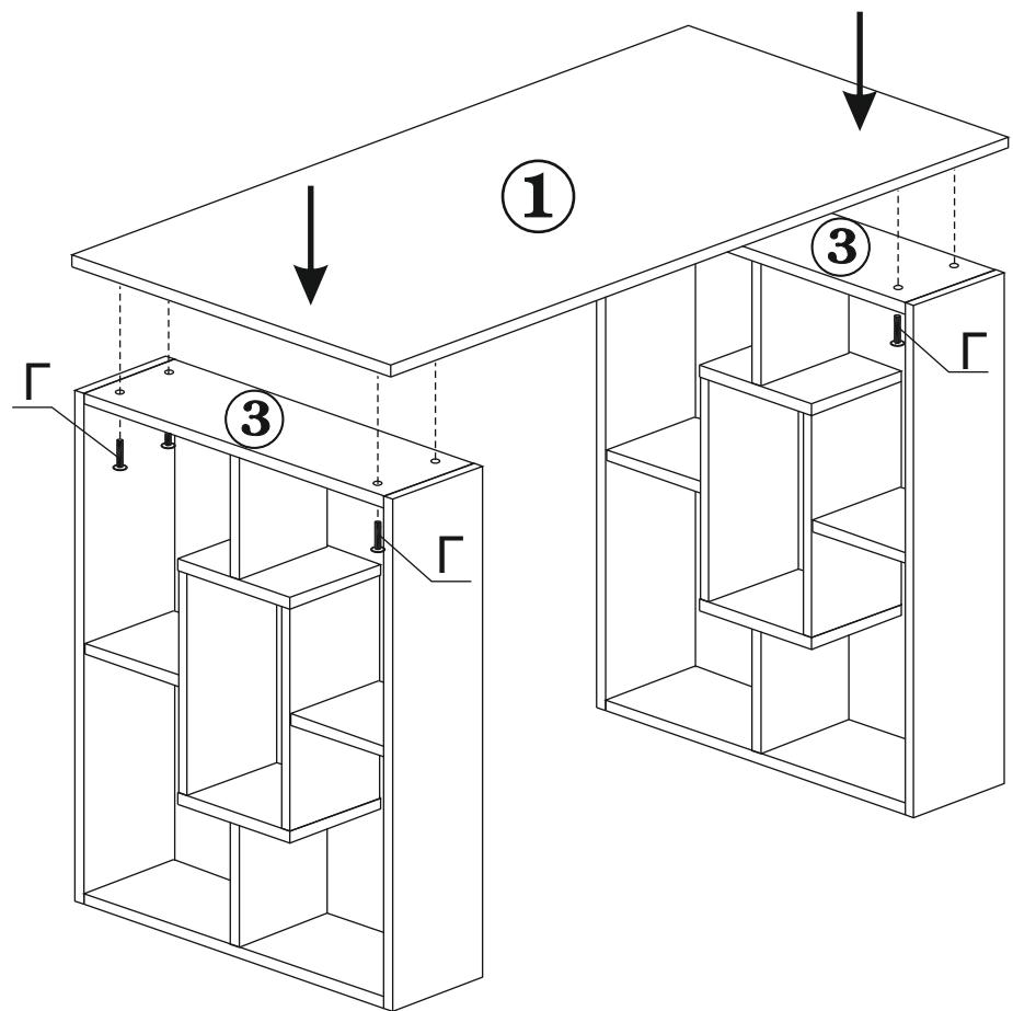
3.2. На две полученные опоры, сверху установите столешницу (дет.№1). Закрепите столешницу винтами (поз.Г). Закрутив их в муфты запрессованные в нижней плоскости столешницы, через крышки (дет.№№3).
