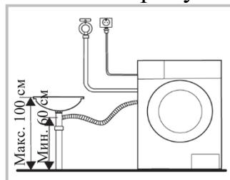
Убедитесь, что сливной шланг верно закреплен на задней стенке стиральной машины на высоте не менее 60 см. Это необходимо для предотвращения преждевременного слива воды в процессе стирки. Дополнительно, Вы можете установить на слив из стиральной машины обратный клапан (приобретается отдельно).
