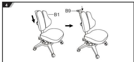
Открутите фиксатор на спинке В1 и наденьте спинку на опорную трубу ВЗ. Затяните фиксатор
