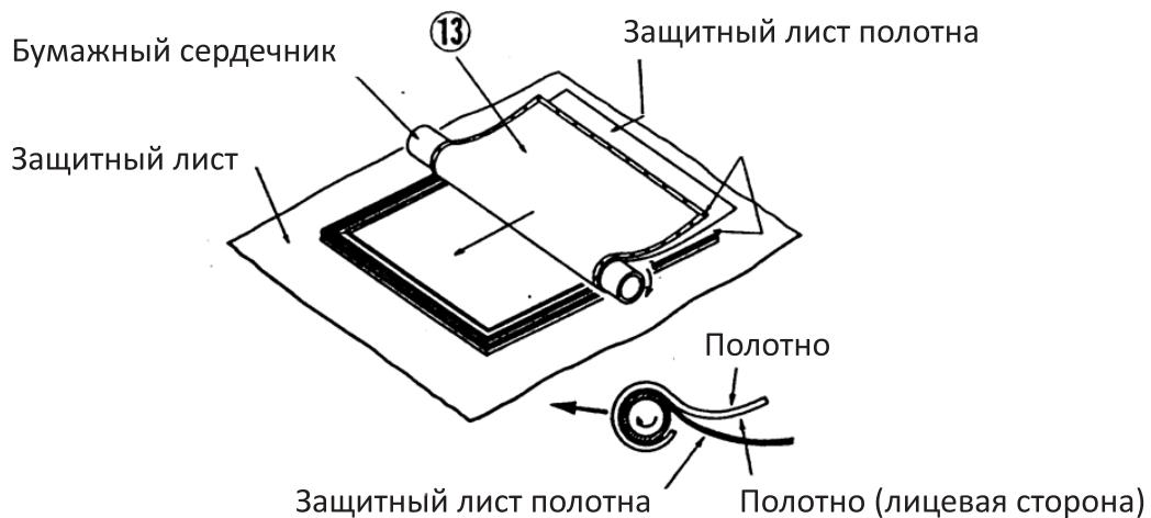
Перед повторной укладкой или переноской экранного листа намотайте его на бумажный сердечник в порядке, обратном его размотке. Сохраните бумажный сердечник для переноски экранного блока в будущем.
