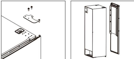
4. Извлеките правый предохранитель и извлеките левый предохранитель из пакета с принадлежностями и установите слева.
