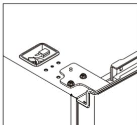
12. Подключите разъемы дверного выключателя и дисплея, а также установите левую верхнюю крышку петли.
