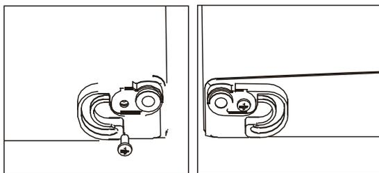
5. Отвинтите нижний шарнир и снимите регулируемую ножку с левой стороны на правую.
