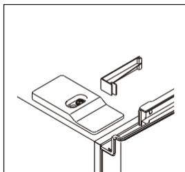
2. Отвинтите правую верхнюю крышку петли и разъедините разъемы дверного выключателя и дисплея.
