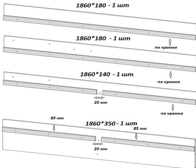
На детали 3 (1860\*350) начертить карандашом линии согласно рисунка в схеме, приложить по линии планку и привернуть шурупами 3,5\*30. На остальных деталях планка приворачивается по кромке деталей (как указано на рисунках)
