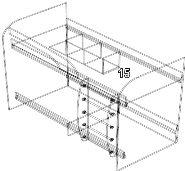
Из деталей 17 и 18 собрать полку, с помощью еврошурупов. Закрепить полку, скрутив низ полки 18 с щитом 4, и боковины 17 с верхним щитом ламели 15, еврошурупами.
