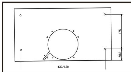
Расположение монтажных отверстий верхней панели шкафа
