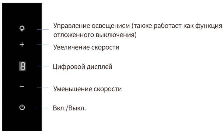
После включения питания все индикаторы загораются, затем гаснут в сопровождении звукового сигнала. В состоянии включения вытяжки элементы "Вкл./Выкл." и "Цифровой дисплей" всегда активны, и каждое нажатие сопровождается звуковым сигналом. Световой индикатор белый.
