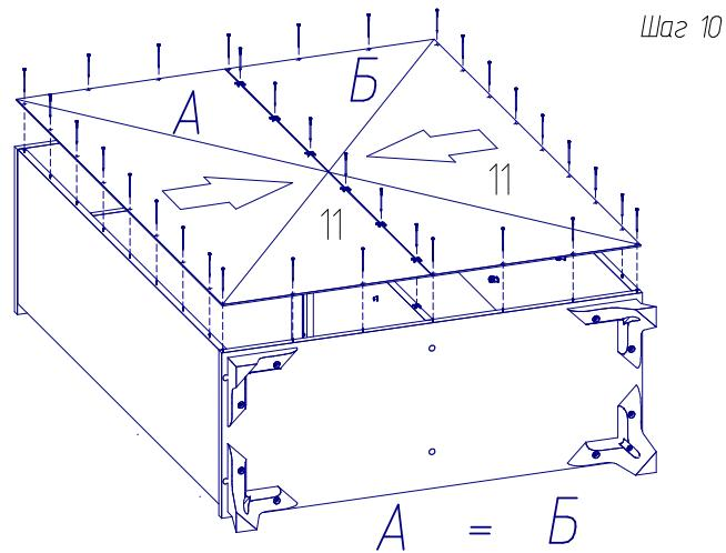
Перед креплением дбрп - проверьте диагональ каркаса.
