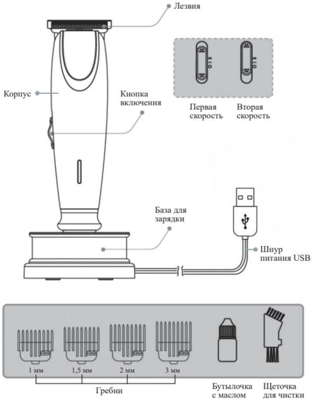
Кнопка включения расположена сбоку устройства. Положения кнопки: снизу — выключено, по центру — первая скорость, сверху — вторая скорость работы.
