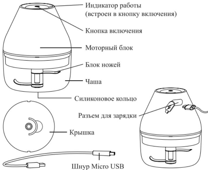
Устройство запускается нажатием на кнопку включения.
