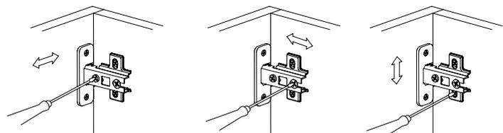
Регулировка вперед-назад. Регулируется крепежным винтом
