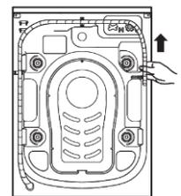
2. Подсоедините сливной шланг к сливному отверстию или перекиньте его через край раковины с помощью U-образного держателя.
