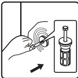
3. Выньте транспортировочный болт вместе с резиновой и пластиковой частью.
