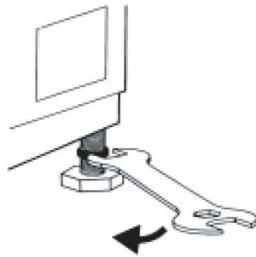
2. Слегка приподнимите машину и отрегулируйте высоту ножки, вращая ее.
