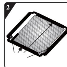
Наклоните машину под углом  $40^{\circ}$  и поверните крышку, как показано на рисунке. Вставьте сторону с вырезом под косым углом между двумя ножными винтами в задней части стиральной машины до упора. Затем установите нижнюю пластину и убедитесь, что она плотно прилегает к дну стиральной машины.
