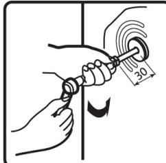
2. Надавите на транспортировочные болты в горизонтальном направлении внутрь и ослабьте транспортировочный болт.
