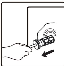
4. Для обеспечения безопасности и снижения уровня шума следует установить пластиковые заглушки, входящие в комплект поставки устройства.
