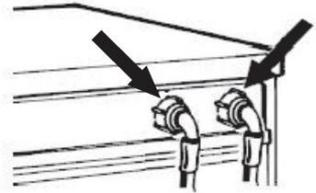
2. Зафиксируйте шланг, затянув гайку.
