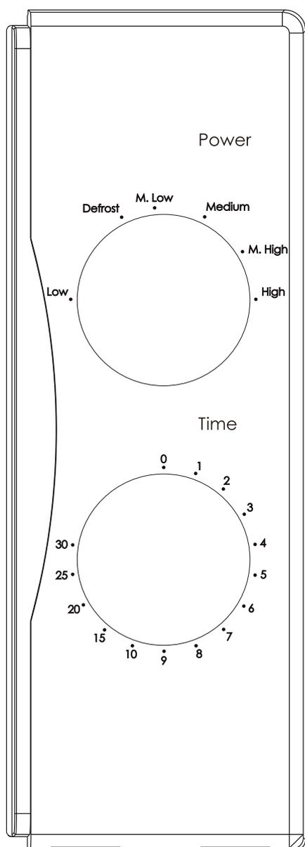
На панели управления расположены две ручки управления. Одна является ручкой управления таймера, а вторая ручкой выбора мощности.
