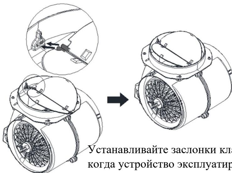
Устанавливайте заслонки клапана только тогда, когда устройство эксплуатируется в режиме вытяжки (подключена к вентиляционному каналу).
