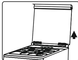
Чтобы крышку было удобнее мыть, снимите её. Для этого полностью откройте крышку и поднимите ее вверх.
