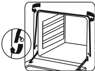
Когда Вы моете плиту внутри, уплотнение двери духовки лучше снять, вынув металлические скобы из отверстий.
