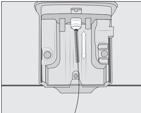
Протолкните щёточку для очистки в паровую форсунку максимум на 1 см.
