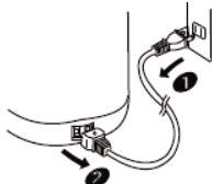
Отключите сетевую вилку от электрической розетки, а затем отсоедините шнур от чайника-термоса.
