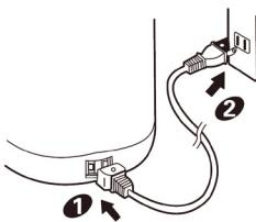
Подключите один конец сетевого шнура к соответствующему разъему на корпусе чайника-термоса, а вилку сетевого шнура – к электрической розетке
