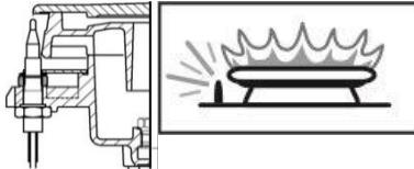
Тепловой аппарат активирует предохранительный механизм и, при переливании жидкости через края, немедленно отключает подачу газа в случае, если верхние конфорки потухли.
