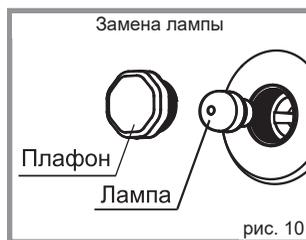
**Примечание:** \*Лампа специального назначения (SPECIAL OVEN) для духовых шкафов, грушевидная, цоколь E14, температурная стойкость 300 °С, мощность - 15 Вт.
