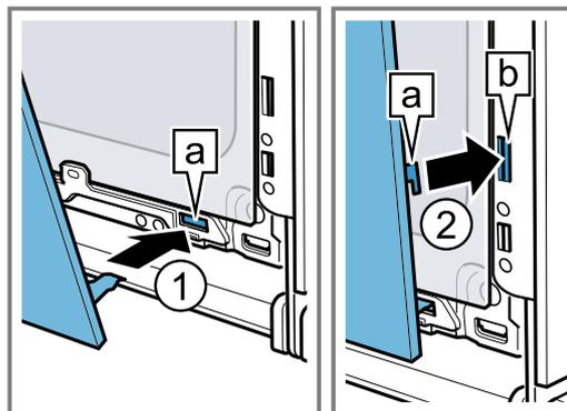
6. Presionar el cristal delantero por abajo ① hasta que se oiga que ha encajado.
