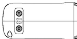
1. Установите насадки-битеры или крючки для замеса теста в соответствующие разъемы на корпусе. Каждая насадка битер может быть установлена в любой разъем. При установке насадок-крючков соблюдайте указания маркировки рядом с разъемами.
