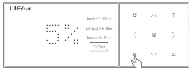
Когда емкость 3G Filter, указанная Smart контроллером, достигает уровня ниже 5%, следуйте приведенным ниже инструкциям для замены фильтра.
