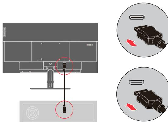
4. При подключении к компьютеру кабеля аналогового сигнала.
