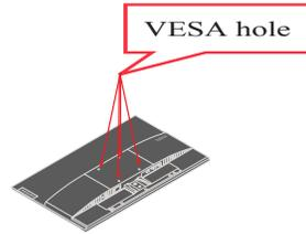
Шаг 5. Закрепите ЖК-монитор на стене в соответствии с инструкциями в комплекте для настенного монтажа.
