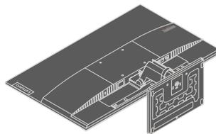
Шаг 4. С помощью винтов M4x10 мм закрепите монтажный кронштейн из комплекта настенного крепления VESA (расстояние между отверстиями 100x100 мм).
