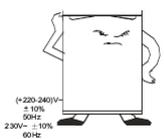
Перед включением холодильника в сеть электропитания убедитесь, что напряжение и частота электросети соответствует указанным на маркировке изделия. Подключайте холодильник к розетке с заземлением. Подключайте холодильник только к источнику переменного тока.
