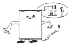
Устанавливайте холодильник в хорошо вентилируемых помещениях. Достаточная вентиляция позволяет холодильнику работать максимально эффективно при низком потреблении мощности, а также способствует отводу тепла. Для обеспечения достаточной вентиляции необходимо обеспечить свободное пространство вокруг холодильника не менее 100 мм со всех сторон и не менее 200 мм сверху.
