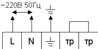
Схема подключения К5, К6 к электрической сети и терморегулятору.
