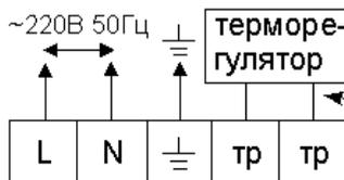
Для подключения терморегулятора необходимо снять перемычку и вместо неё подключить терморегулятор.
