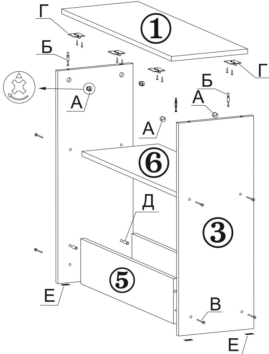
1.1. В отверстия на столешнице (дет.№1) закрутите штоки эксцентриков (поз.Б), шурупами 3,5x16 закрепите карточные петли (поз.Г).
