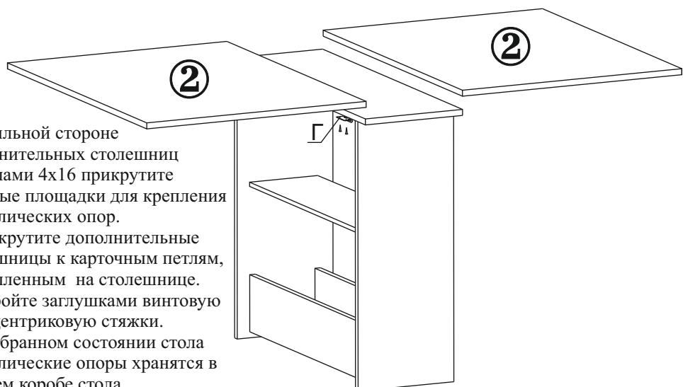
1.2. К тыльной стороне дополнительных столешниц шурупами 4x16 прикрутите опорные площадки для крепления металлических опор.
