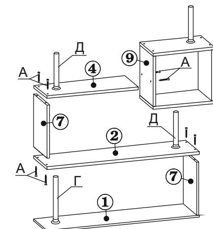
3.1. На детали №1, №2, №3, №4, №5 и №6 с помощью шурупов (поз. Е) установите штангодержатели (поз.В). Снизу на основании (дет.№1), с помощью шурупов (поз.3) установите опоры (поз.Б). Винтовой стяжкой (поз.А), закрепите деталь №7. В штангодержатель установите трубу (поз.Г), и зафиксируйте ее стопорным винтом расположенным в штангодержателе с помощью ключа (поз.Л).
