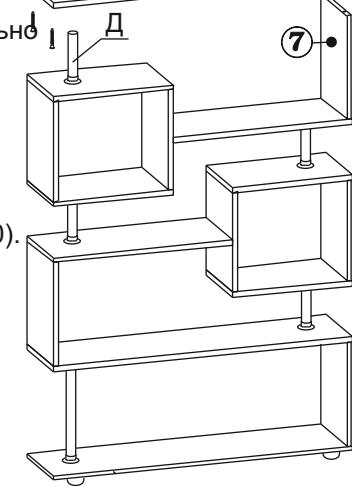
3.6. Стыльной стороны стеллажа, установите и закрепите винтовой стяжкой заднюю планку (дет.№10).
