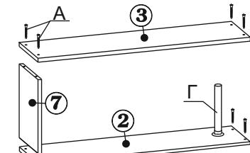
3.5. Присоедините и закрепите последовательно оставшиеся детали №2, №7 и №3, а также трубу (поз.Г).
