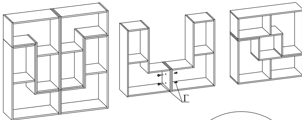
3.5. В целях безопасности рекомендуется закрепить конструкцию к стене при помощи монтажного уголка (поз.Е), И прилагаемых шурупов 4x16 и 4x40. Предварительно просверлив в стене отверстие диаметром 6 мм, и забив туда пластиковый дюбель.
