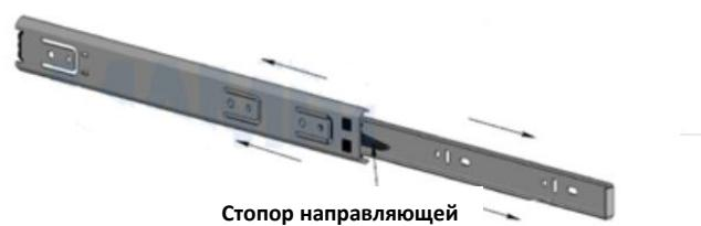
Перед установкой направляющие нужно разъединить. Для этого стопор правой направляющей следует поднять вверх, левой - опустить вниз. Затем соединить их, вставив друг в друга, произойдет щелчок.
