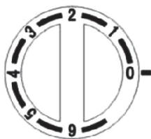
Регулятор температуры предназначен для выбора оптимальной температуры хранения. После любого изменения положения регулятора, должно пройти определённое время, прежде чем температура достигнет вновь установленной величины.
