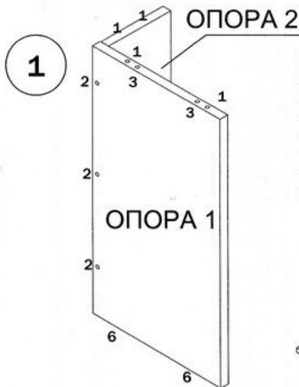
2. Закрутить дюбеля стяжки-растекс (4) в столешницу СКЛ ИГР-120-01. Прикрутить опоры 720 как показано на сх.2 саморезами (9). Соединить столешницу с опорами ОПОРА 1 и ОПОРА 2 собранными в п.1. При необходимости произвести регулировку опор 720 по высоте.
