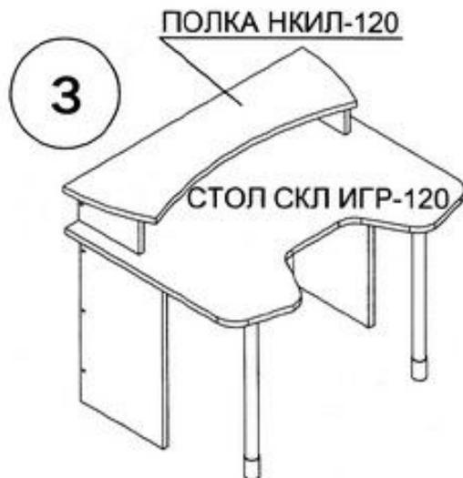
При необходимости, для уменьшения перемещения полки по столу, на боковины полки НКИЛ-120 приклеить клеящие пятки (6). Затем снять защитную пленку с клеящих пятков (6), и только после этого полка НКИЛ-120 устанавливается на стол СКЛ ИГР-120. Поставить декоративные заглушки (7) и (8) в местах установки евроинтов (2) и стяжек-растекс. (3)
