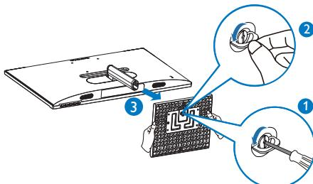
3. Снимите руками крышку шарнира с корпуса монитора.
