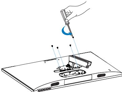
2. Открутите отверткой винт, расположенныйный в нижней части основания, и снимите основание с подставки.
