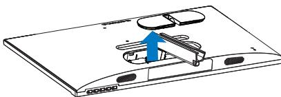
4. Отверткой открутите винты на кронштейне и снимите кронштейн/подставку с монитора.
