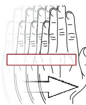
Для включения вытяжки, надо двигать рукой горизонтально слева направо. Точно таким же образом можно переключать скорости:
