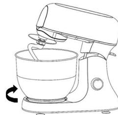
3. Вставьте насадку на шпиндель, чтобы штифт на оси попал в паз на насадке, затем слегка надавите на насадку и поверните ее против часовой стрелки до упора.
