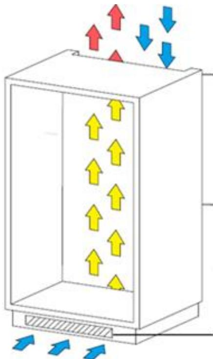
В верхней части шкафа сделайте зазор для вентиляции. Воздушный поток должен свободно проходить и выходить наружу. Рекомендуемый размер зазора: 500 x 30 мм
