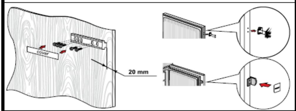
7. Установите крышку петли в следующем положении.
