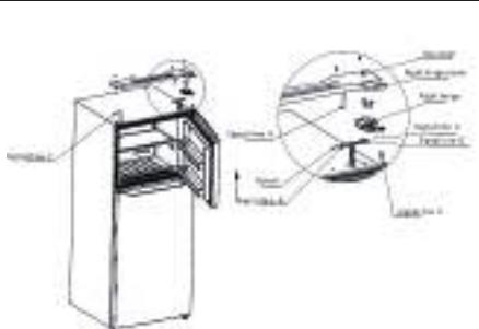
2 Открутите винты, удерживающие верхнюю накладку. Приподнимите накладку, разъедините контакты А и В, выньте датчик. Отделите накладку верхнего шарнира от верхней накладки. Разъедините контакты Е и D, затем открутите винты верхнего шарнира и снимите дверь морозильного отделения. Сохраните снятые шарнир и его накладку для возможного использования в будущем.
