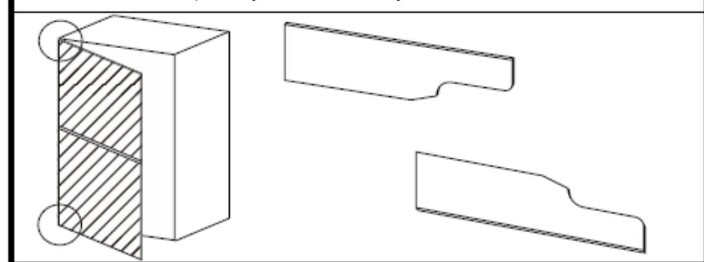
**8.** Зафиксируйте две верхние точки, затем наденьте крышку.
