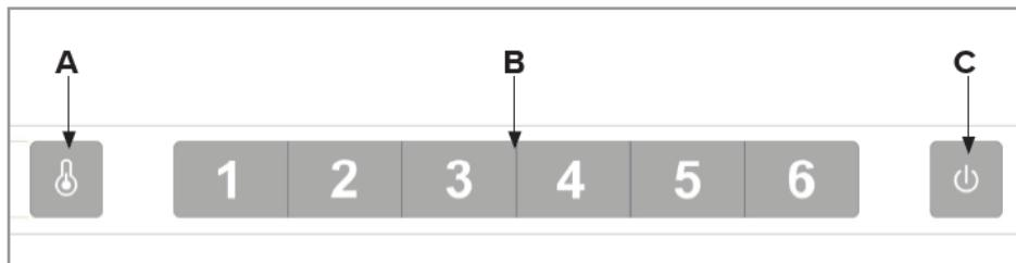
**A. Кнопка датчика регулировки температуры холодильника.**
