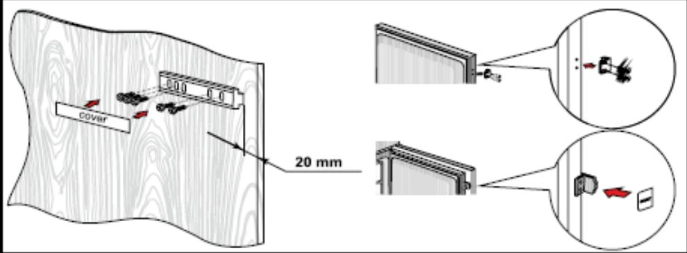
**7.** Установите крышку петли в следующем положении.
