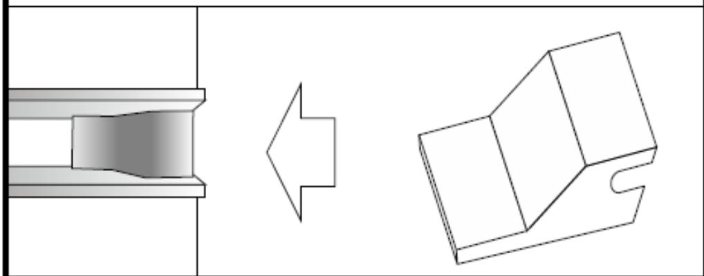
**10.** В конце установки, проверьте зазор между деревянной дверью и шкафом. Зазор должен быть менее 1 мм.
