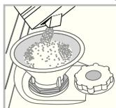
1. Wyjąć kosh dolny i odkręcić korek pojemnika, obracając go w kierunku przeciwnym do ruchu wskazówek zegara.
