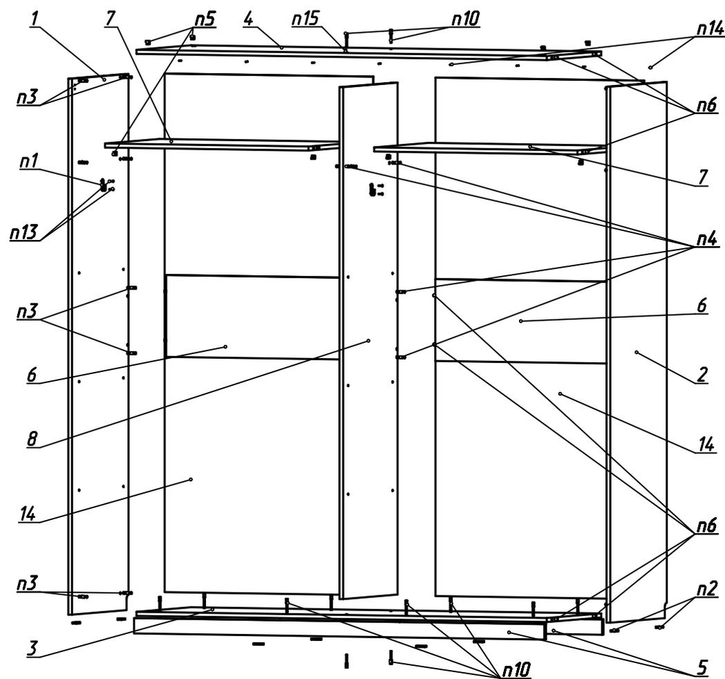
4.2. Установите в стойки (дет.№9 и №11) футорки (поз.11). Винтами (поз.12) прикрепите стойки к боковинам шкафа. Установите фасады (дет.№12 и №13). Инструкция по установке и регулировке фасадов купе системы "РИАЛ" - <https://rial.pro/>. Установите горизонталь (дет.№10) и закрепите евровинтами (поз.9). Установите штанги (дет.№15)
