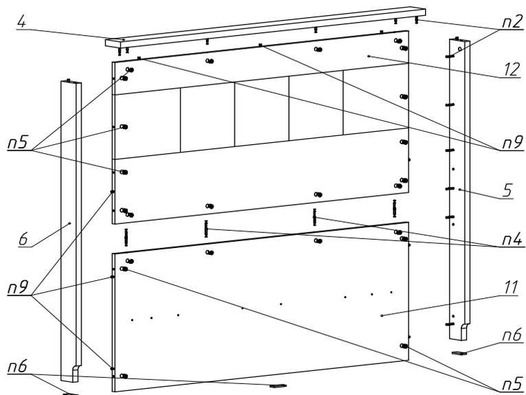
4.2. Установите на детали кровати шканты (поз.9), штоки эксцентриков (поз.2) и подпятники (поз.6). Соедините среднюю опору (дет.№7) и продольные опоры (дет.9) с помощью 2-х сторонних штоков (поз.3) и эксцентриков (поз.5). Евровинтами (поз.1) прикрепите опору (дет.№8) и панели (дет.№10). Установите и закрепите эксцентриками (поз.5), боковые царги (дет.№1 и №2) и переднюю царгу (дет.№3)
