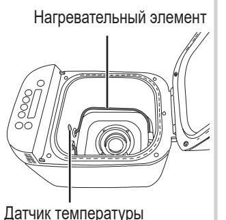
Используйте влажную ткань для протирания внутренней части устройства, кроме нагревательного элемента и области температурного датчика.
