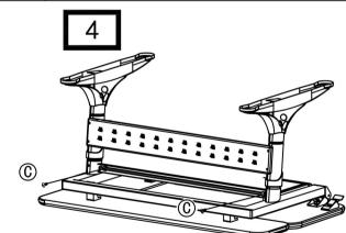
Разместите резиновую втулку на приводе таким образом, чтобы отверстие на втулке совпадало с отверстием на самом приводе. Вкрутите винты С и затяните до конца винты А.
