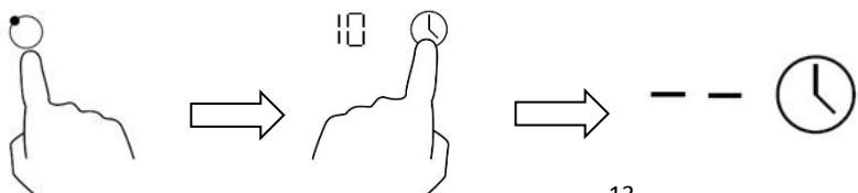
5. После установки заданного времени обратный отсчёт начинается немедленно. На дисплее отображается оставшееся время, а индикатор таймера мигает в течение 5 секунд.
