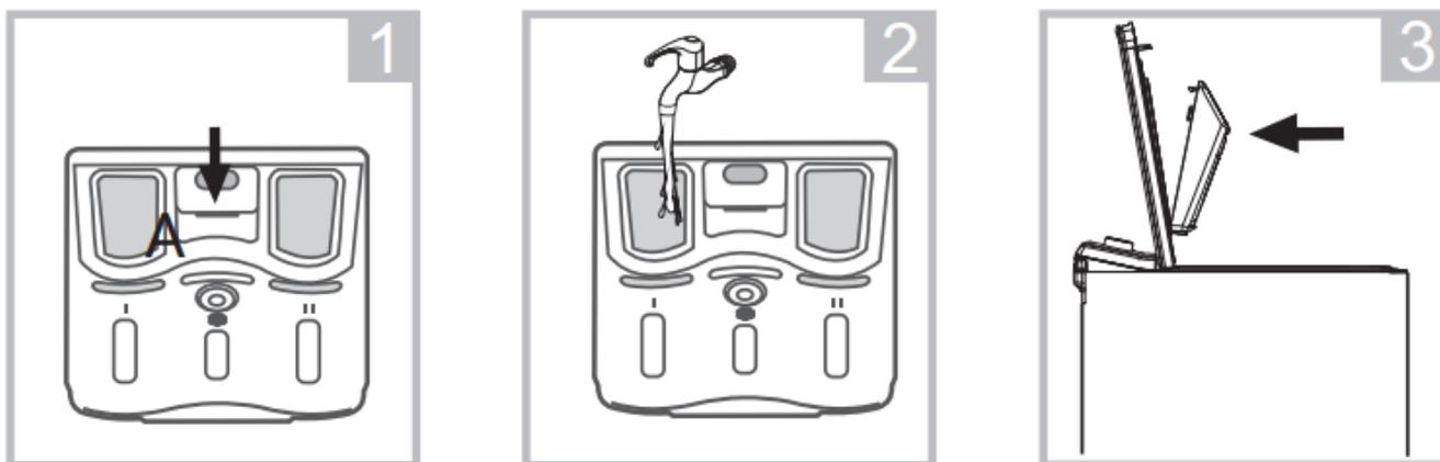
1. Нажмите кнопку со стрелкой на крышке, внутри дозатора.
